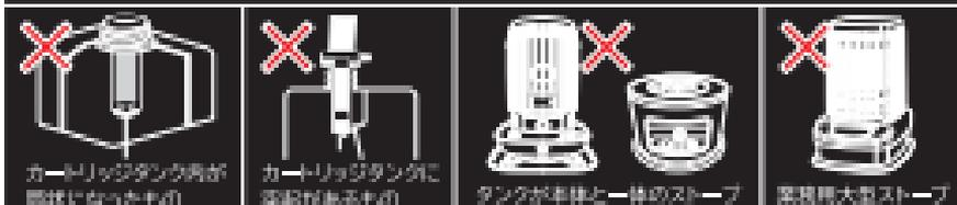
※カートリッジタンクなどの給油口内径22mm以下のもの、灯油缶などの吸入口内径33mm以下のものにはご使用になれません。
